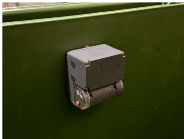
安装在垃圾桶内的智能垃圾桶传感器
