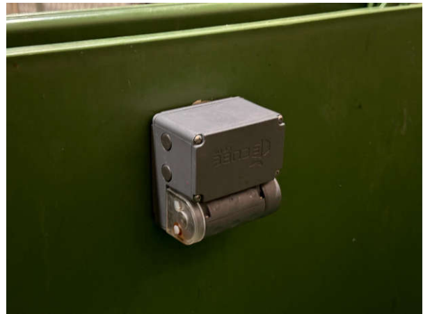
安裝在垃圾桶內的智能垃圾桶傳感器
